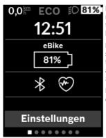
181% La pantalla de estado muestra, además de la barra de estado, la hora actual y el estado de carga de todas las baterías de su eBike
